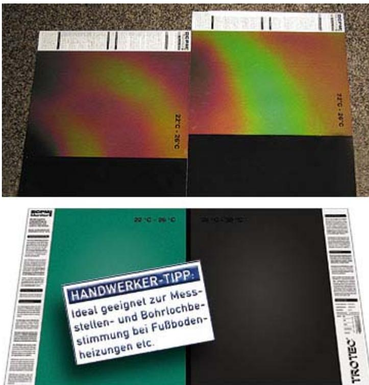
Auf Souvenirmärkten finden Sie häufig Thermometer, bei denen eine einfache Folie mit der farbigen Zahl aufleuchtet, die die jeweilige Temperatur anzeigt. Es handelt sich um Thermosensible Folien. Das Gleiche System verwendet man seit ca.: 8-10 Jahren zum Orten von Heizschlangen ☺
