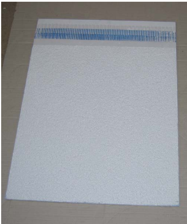
Putzplatte waagrecht eben gelagert Fallrohr mit Kugel in 1m Höhe
