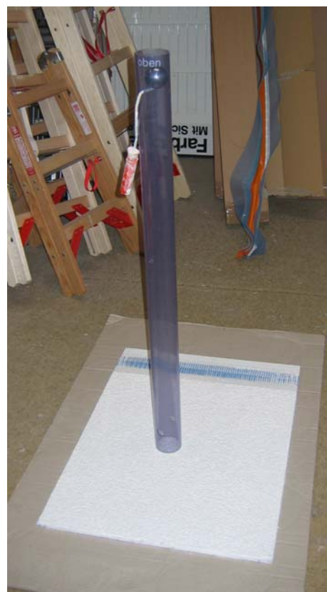
Putzplatte waagrecht eben gelagert Fallrohr mit Kugel in 1m Höhe
